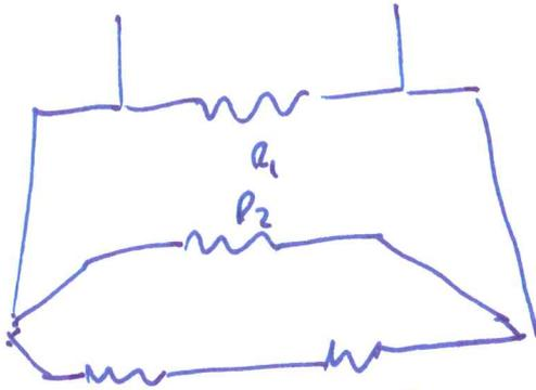
$$\frac{R_3 R_5}{R_3 + R_5} \quad \frac{R_4 R_6}{R_4 + R_6} \rightarrow 26.1 \Omega, 16.7 \Omega$$
